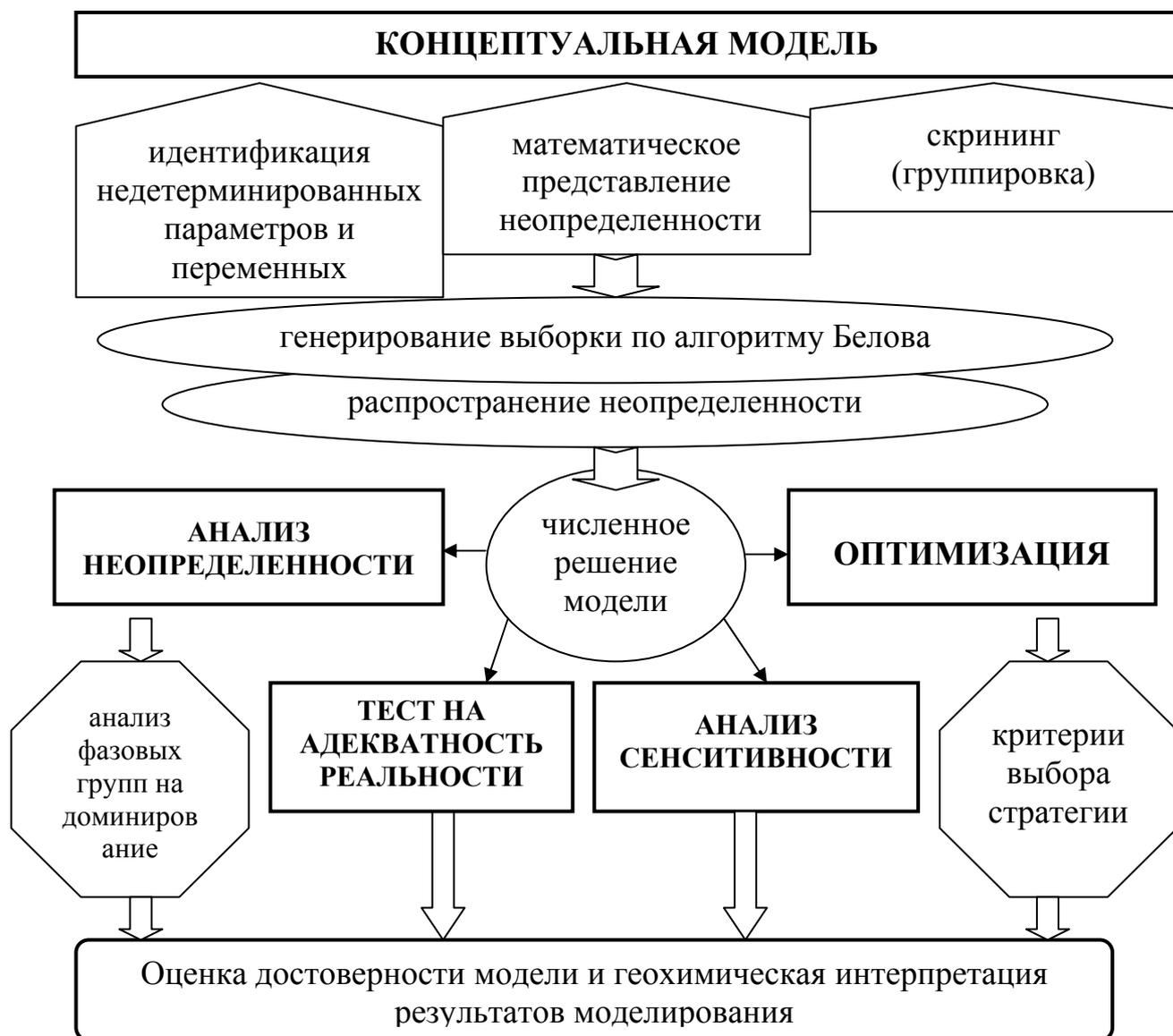
**Рис. 1. Блок-схема физико-химического моделирования геохимической системы на основе минимизации энергии Гиббса с недетерминированными входными данными.**
